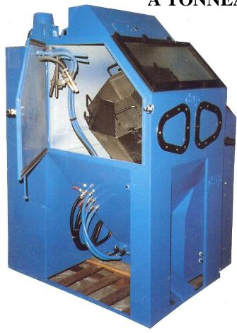
entièrement automatique recyclage de l'abrasif en continu armoire de filtration intégrée deux buses de sablage indépendantes mise en route par minuterie tableau de commande 24 v
